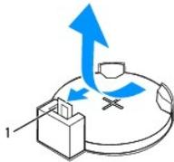
1 | leva di sblocco della batteria
